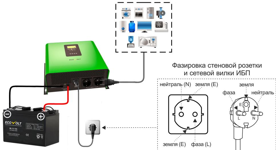
**Внимание:** Прибор специально разработан для электроснабжения фазозависимых котлов и поэтому имеет сквозной ноль. При проведении теста на пропадание сетевого электричества не вынимайте вилку из стеновой розетки, иначе произойдет обрыв ноля на входе прибора и соответственно на входе котла, что приведёт к некорректной работе фазозависимого котла. Соблюдайте ориентацию фазы и ноля.
